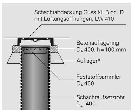
Schachtabdeckung auf Schacht (z. B. Kontrollschacht)
