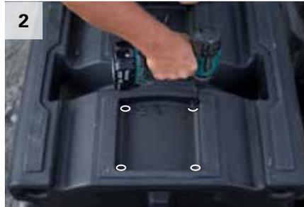
In den Ecken der zurückgesetzten Fläche jeweils ein Loch bohren, Ø min. 12 mm (Bohrdurchmesser muss größer sein als das zu verwendende Sägeblatt).
