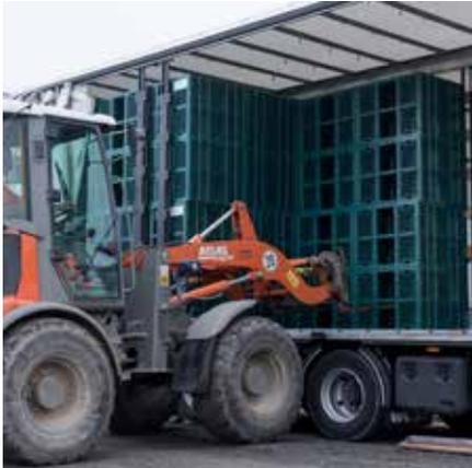
Die Rigofill inspect Blöcke werden jeweils zu 4 Stück (Halbblöcke zu 8 Stück) verpackt geliefert. Die Pakete sind vorzugsweise mit Stapler, Kran oder anderem Hebegerät zu entladen. Bagger müssen die erforderliche technische Ausrüstung für den Hebezeugbetrieb besitzen.
