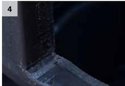
Die entstandenen Grate und Unebenheiten der Trennfläche sind mit Schaber, Feile oder sonstigem geeignetem Werkzeug zu entfernen.
